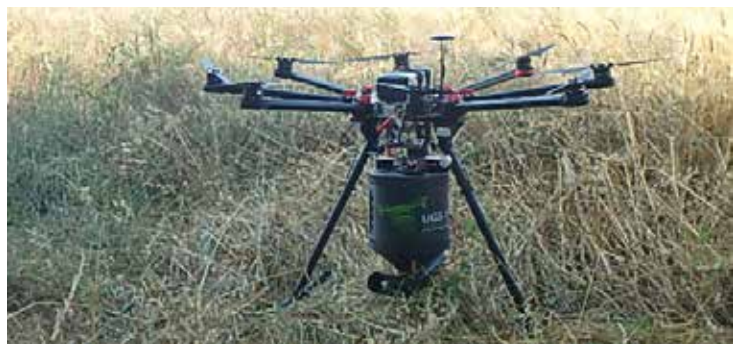
Drone équipé du module de semis, charge utile 3-4 kg
