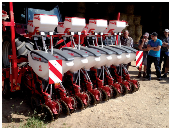
Semoir monograine Sola semis direct utilisé pour le maïs. Il peut semer sur 8 rangs avec un écartement de 37,5 cm. On peut ainsi augmenter la densité jusqu'à 110 000 grains/ha tout en gardant une bonne répartition. Photo de droite : maïs semé en semis direct au stade 6 feuilles.
