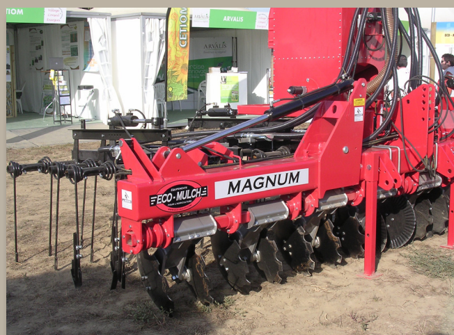
La herse Magnum est utilisée pour répartir et broyer les pailles.
