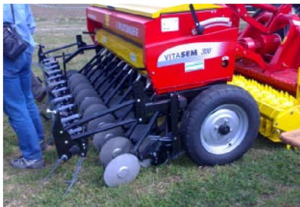
2. **Le type rotative-semoir** (voir photo) classique est recommandé sur les reliefs grossiers mottés, son intérêt réside dans l'agressivité des dents rotatives favorisant la diminution des calibres des mottes.
