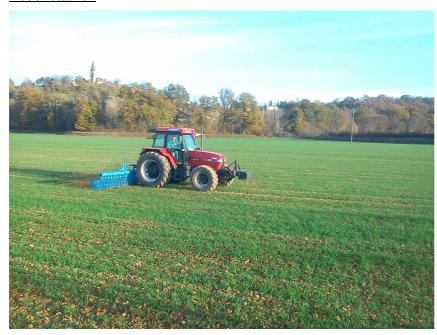
Seule la pression réglable des ressorts influera sur la pénétration des doiats des roues étoilées dans le sol. est important de s'assurer de la fragmentation de 100 % de la surface du sol. Dans le cas inverse, vérifier l'écartement entre les roues étoilées (9 cm en moyenne), augmenter la compression des ressorts jusqu'à l'obtention d'une pénétration intégrale. Sous les passages des roues la pression des ressorts sera toujours maximale.
